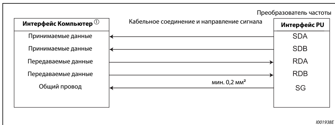
Рис. 6-113: Кабельное соединение с преобразователем частоты
