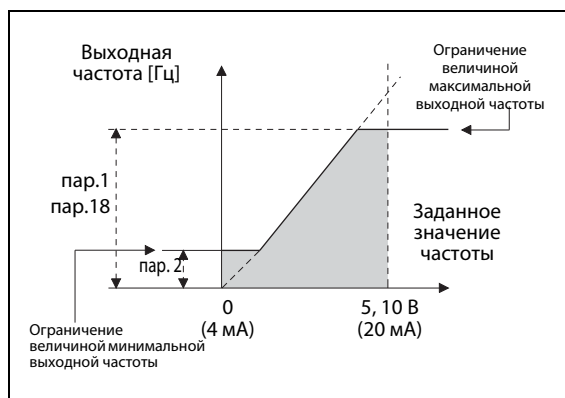
Рис. 6-10: Минимальная и максимальная выходная частота
