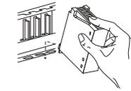
① Après avoir coupé l'alimentation électrique, introduire la patte inférieure du module dans le trou de guidage de l'appareil de base.
