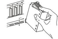
① Отключив напряжение питания, вставьте нижний выступ модуля в направляющее отверстие на базовом шасси.
