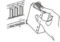
① Nachdem Sie die Netzspannung ausgeschaltet haben, setzen Sie das Modul mit der unteren Lasche in die Führung des Baugruppenträgers ein.
