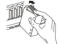
② Seguidamente empuje el módulo contra la unidad base hasta que el módulo quede pegado a la misma.
