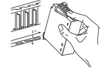
① Después de haber desconectado la tensión de red, ponga el módulo con el saliente inferior en la guía de la unidad base.
