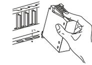
① Una volta disinserita la tensione di rete, introdurre il modulo nella guida del rack con la linguetta inferiore.
