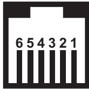
Abb. 3-9 1 - b2 2 - W 3 - a 4 - b 5 - E 6 - a2 Das Mitsubishi Alarm Modem 56k unterstützt die a/b-Leitungen (3 und 4).
