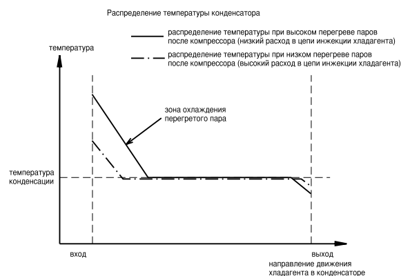
Рис. 6. Распределение температуры конденсатора
