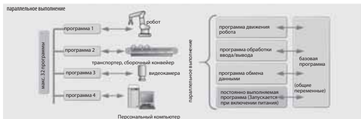
Функция многозадачного режима обработки данных для параллельного выполнения нескольких подпрограмм
