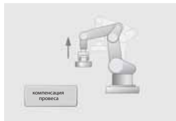
Компенсация силы тяжести для повышения точности позиционирования и фасовки
