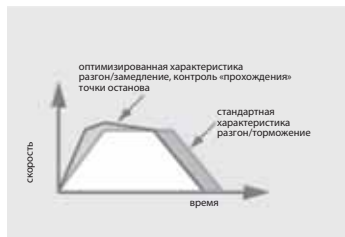
Автоматическая оптимизация характеристики разгон/замедление для сокращения периода цикла
