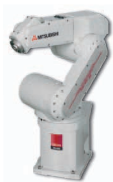
Les robots à bras articulés sont équipés de connecteurs électriques et d'alimentation en air comprimé internes.
