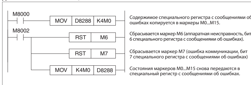
Рис. 10-17: Пример для сброса сообщений об ошибках модуля FX3U-4AD-PT-ADP, установленного в качестве 3-го аналогового адаптерного модуля (1-го модуля в случае FX3G).
