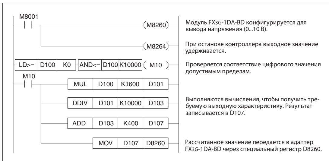
Рис. 6-14: Пример программы для изменения характеристики потенциального выхода
