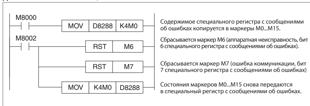
Рис. 12-19: Пример для сброса сообщений об ошибках модуля FX3U-4AD-PNK-ADP, установленного в качестве 3-го аналогового адаптерного модуля (1-го модуля в случае FX3G).
