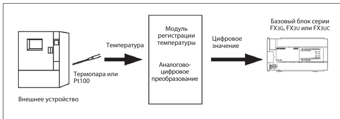
Рис. 1-2: Пример измерения температуры при помощи программируемого контроллера MELSEC серии FX
