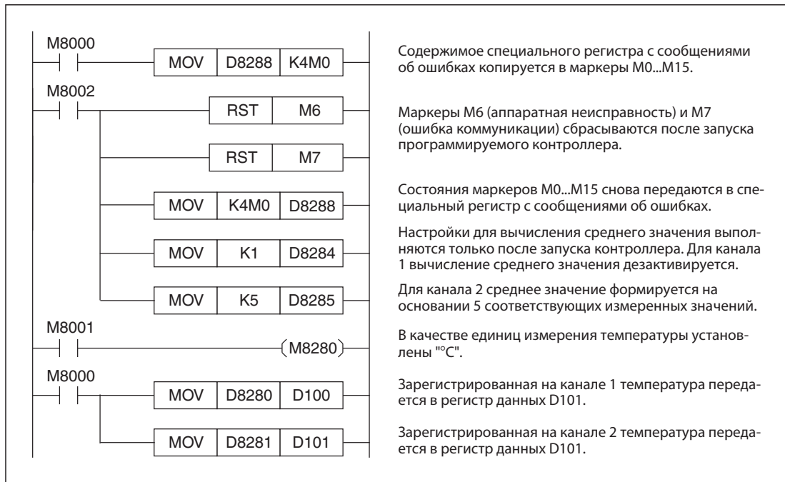
Рис. 11-22: Пример программы для конфигурирования канала 1 и 2 в модуле FX3U-4AD-PTW-ADP
