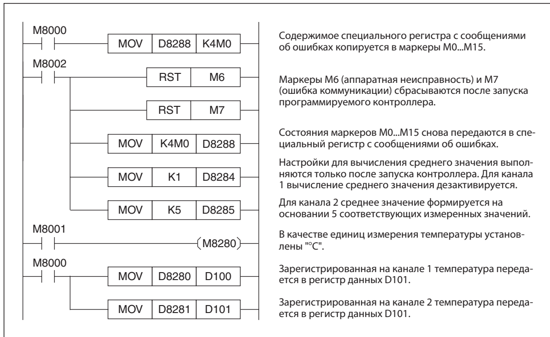
Рис. 10-22: Пример программы для конфигурирования канала 1 и 2 в модуле FX3U-4AD-PT-ADP
