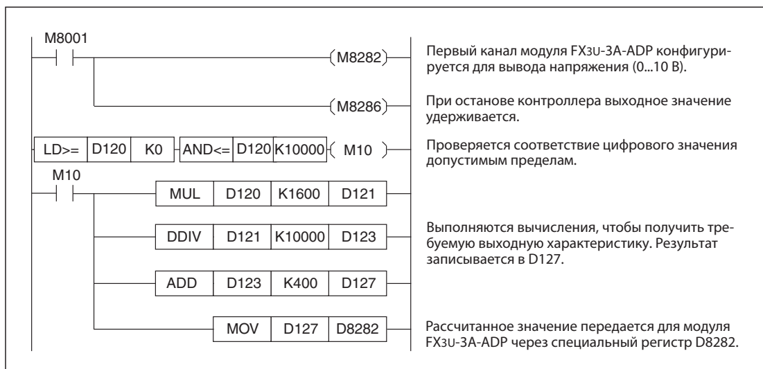
Рис. 9-33: Пример программы для изменения характеристики потенциального выхода
