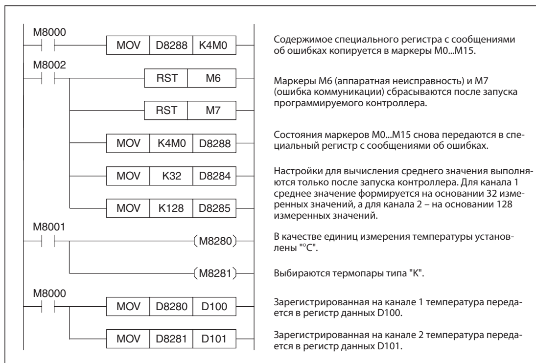
Рис. 13-25: Пример программы для конфигурирования канала 1 и 2 в модуле FX3U-4AD-TC-ADP
