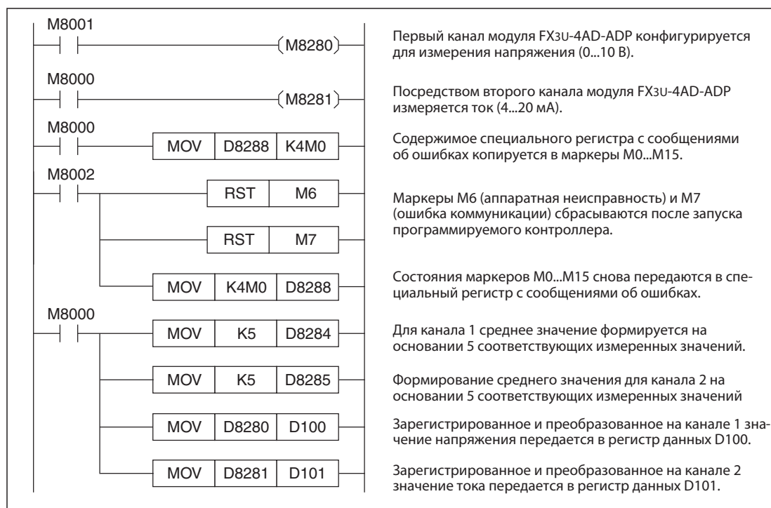
Рис. 4-22: Пример программы для конфигурирования канала 1 и канала 2 модуля FX3U-4AD-ADP
