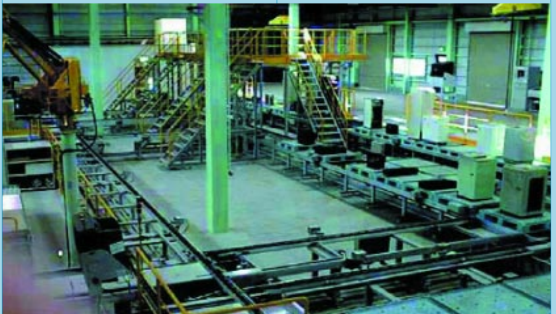
конвейер по демонтажу телевизоров
