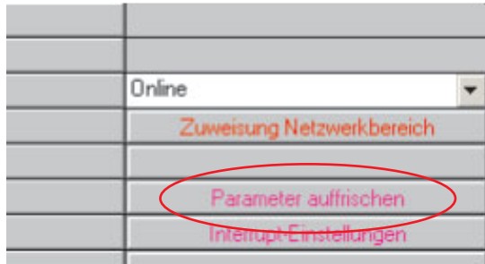
Abb. 10-34: Anschließend werden die Parameter für den Datenaustausch zwischen MELSEC-NET/H und SPS-CPU eingegeben. Klicken Sie dazu auf Parameter auffrischen , und geben Sie die unten abgebildeten Werte ein.
