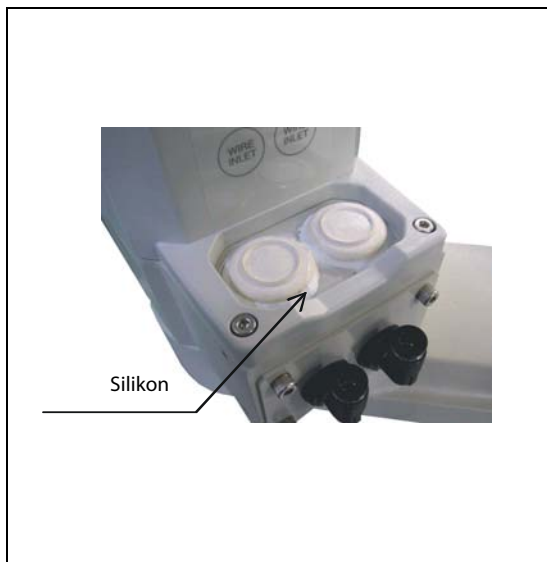
Abb. 2-17: Durchführungsabdeckungen mit Silikon abdichten
