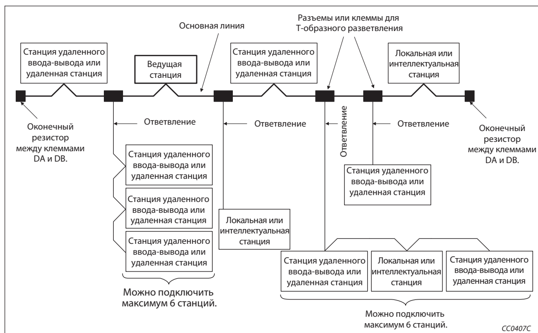
Рис. 7-7: Построение коммуникационной сети с T-образными разветвлениями
