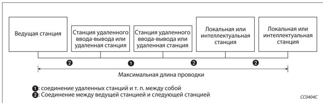
Рис. 3-3: Построение коммуникационной сети с удаленными станциями, станциями удаленного ввода-вывода, локальными станциями и интеллектуальными
