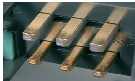
Позолоченные контакты обеспечивают долгий срок службы и имеют минимальное сопротивление, даже после множества циклов использования.
