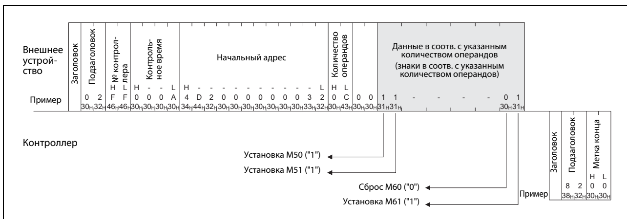
Рис. 8-26: В этом примере изменяется состояние двенадцати операндов M50...M61 (данные в кодировке ASCII)
