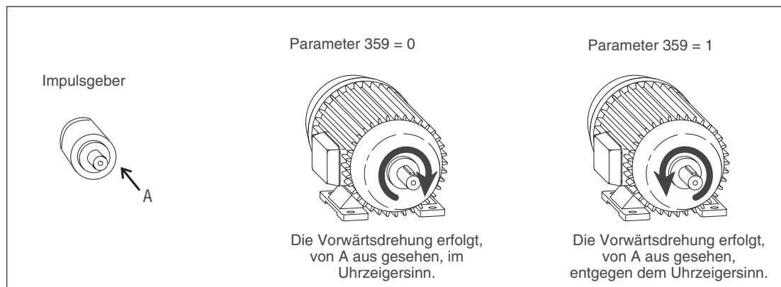
Abb. 4-4: Einstellung der Drehrichtung des Impulsgebers
