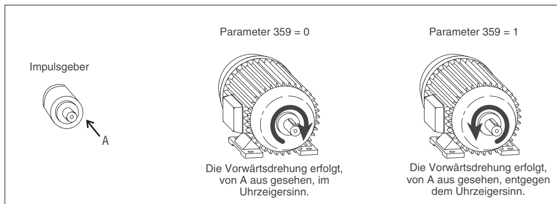
Abb. 3-6: Einstellung der Drehrichtung des Impulsgebers
