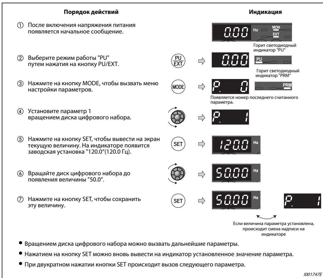
Рис. 5-6: Установка максимальной выходной частоты
