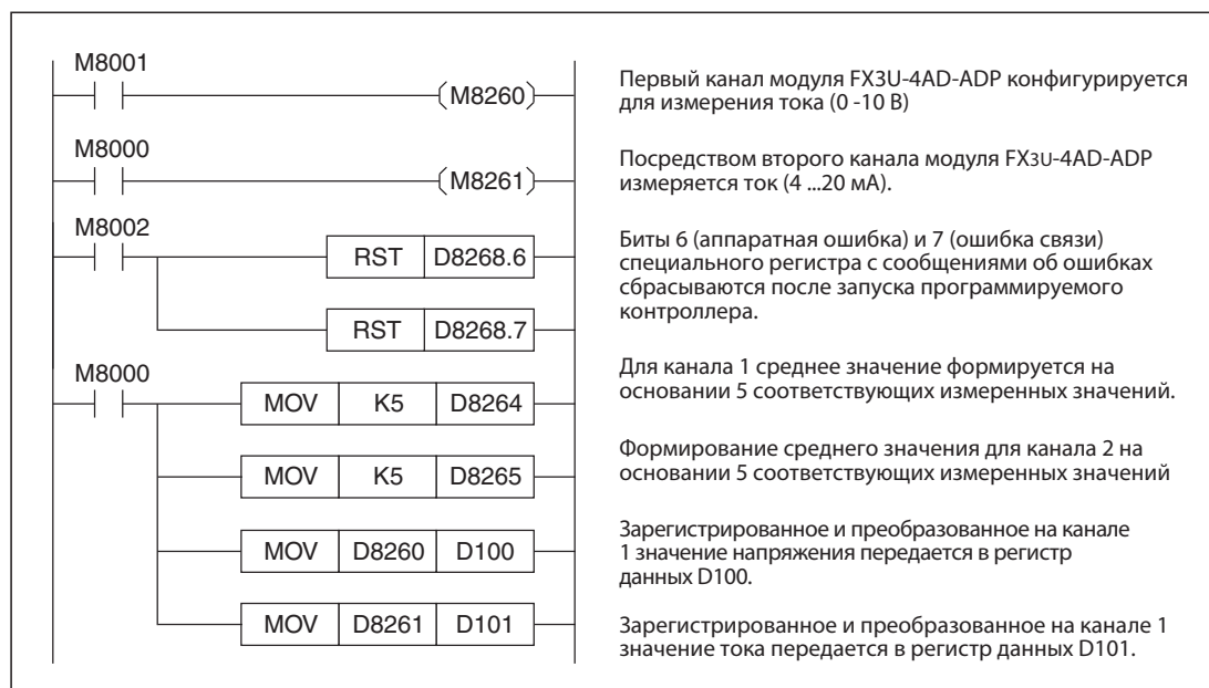
Рис. 3-17: Пример программы для конфигурирования канала 1 и канала 2 модуля FX3U-4AD-ADP, установленного в качестве первого аналогового адаптерного модуля.
