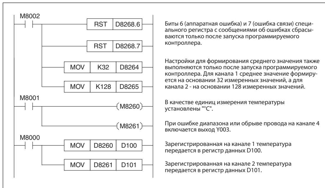
Рис. 8-20: Пример программы для конфигурирования канала 1 и 2 в модуле FX3U-4AD-TC-ADP, установленном в качестве первого аналогового адаптерного модуля.
