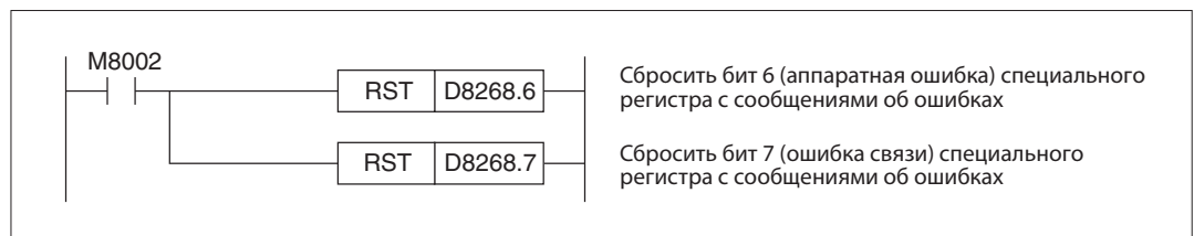
Рис. 3-14: Пример для сброса сообщений об ошибках модуля FX3U-4AD-ADP, установленного в качестве первого аналогового адаптерного модуля. Специальный маркер M8002 устанавливается только в первом цикле после включения программируемого контроллера.
