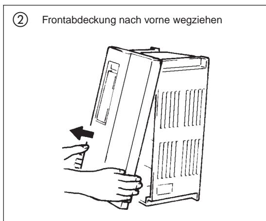
Abb. 1-8: Entfernen der Frontabdeckung
