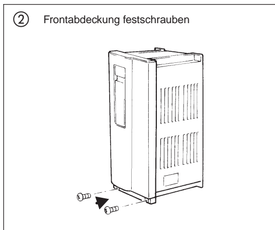
Abb. 1-10: Anbringen der Befestigungsschrauben an der Frontabdeckung
