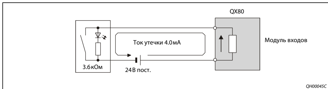
Рис. 0-1. Подключение выключателя входного сигнала к модулю входов
