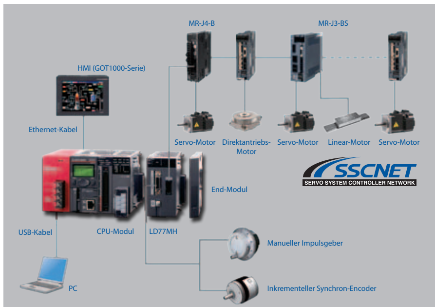
Aufbau eines integrierten Systems, bestehend aus Servoverstärkern und Servomotoren zusammen mit einer SPS-CPU der L-Serie.
