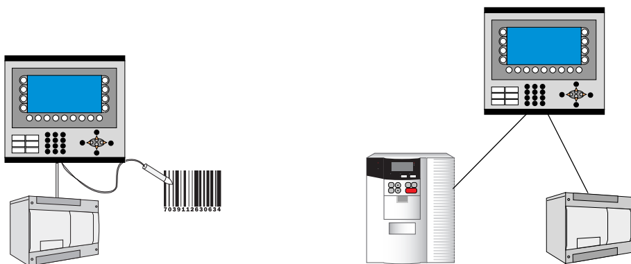
Bedienterminal mit angeschlossenem Anschluss Controller und Barcode-Leser
