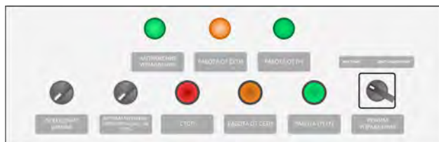
Рис. 6–5. Панель управления системы автоматического байпаса
