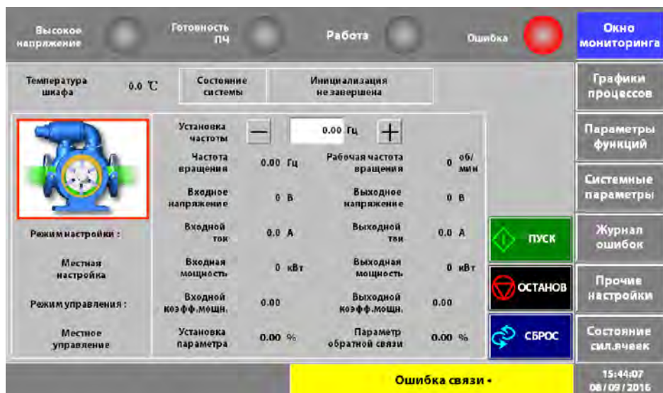
Рис. 5–16. Окно мониторинга для насосных применений
