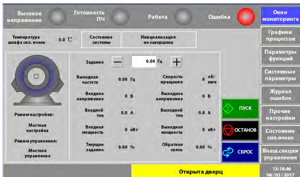
Рис. 5–2. Окно мониторинга при местном режиме управления
