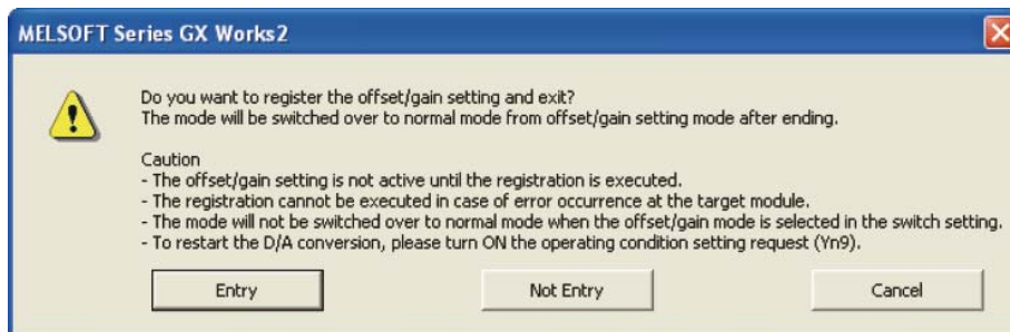
Abb. 5-44: Anschließend haben Sie die Möglichkeit, die Einstellungen im Modul zu speichern und sie damit zu aktivieren. Klicken Sie dazu auf Entry (Eintragen ins Modul).
