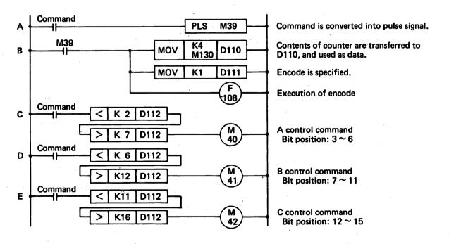
Fig. 5.4.12.4 Encode Circuit Composition
