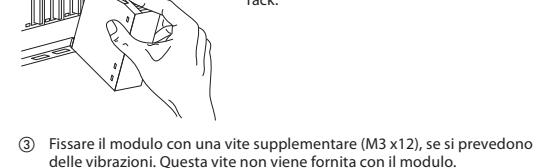
③ Fissare il modulo con una vite supplementare (M3 x12), se si prevedono delle vibrazioni. Questa vite non viene fornita con il modulo.
