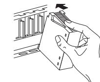
③ Jeśli spodziewane są duże drgania, moduł należy umocować do płyty bazowej za pomocą dodatkowej śruby (M3 x 12). Śruba ta nie jest dostarczana wraz z modelem.
