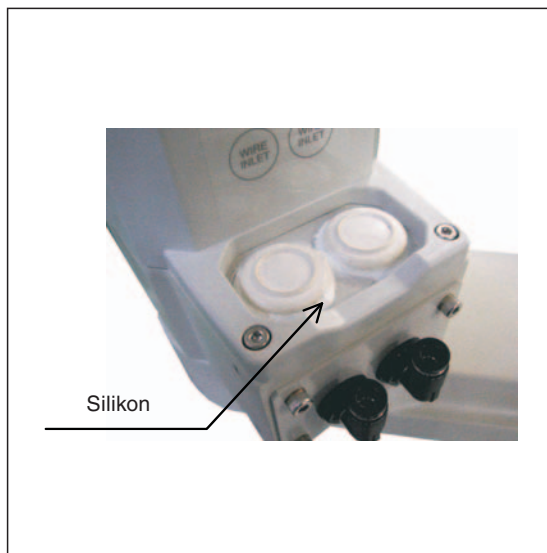
Abb. 2-15: Dichtungen mit Silikon abdichten
