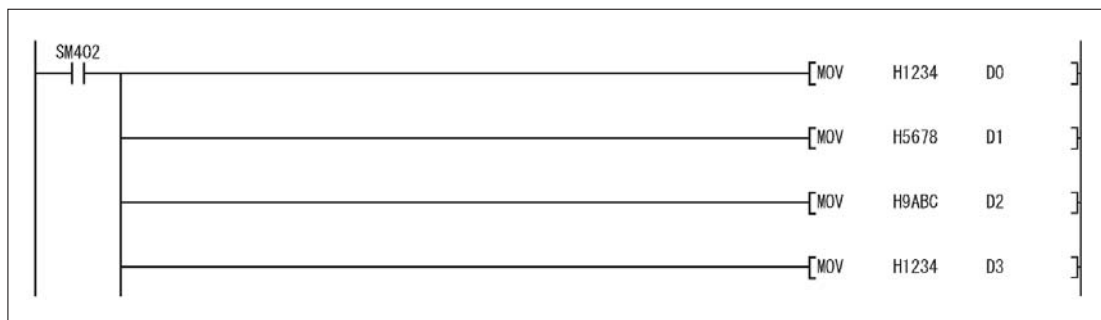
Abb. 3-5: Programm zum Schreiben der Daten in die Register D0 bis D3
