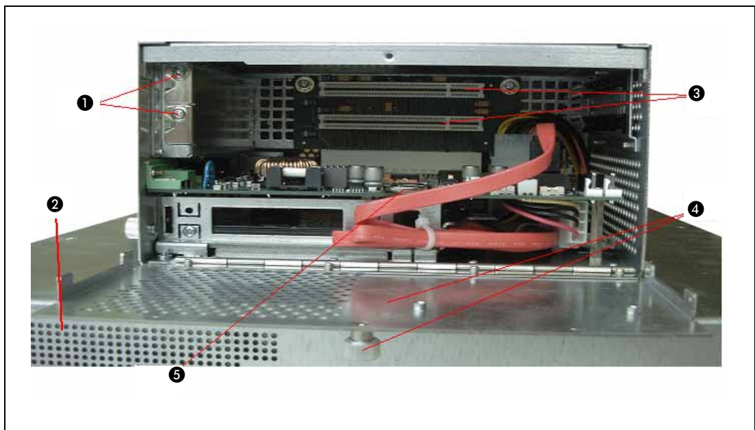
Abb. 2-3: IPC-Bediengerät bei geöffneter Steckplatzabdeckung
