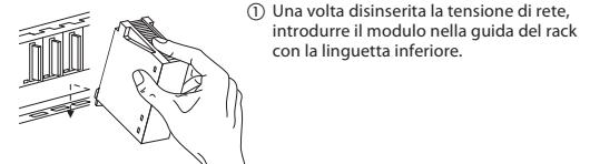
① Una volta disinserita la tensione di rete, introdurre il modulo nella guida del rack con la linguetta inferiore.
