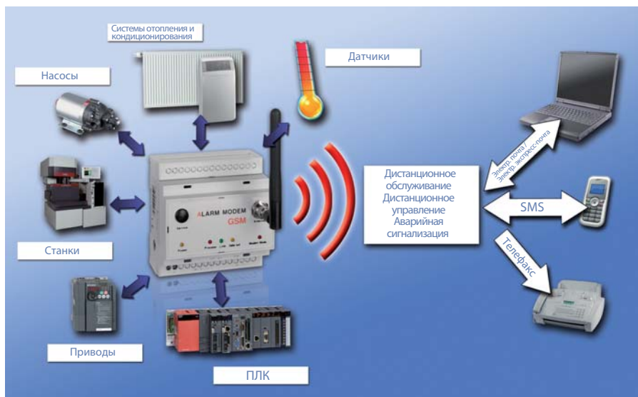
Интеллектуальные модемы от компании Mitsubishi удачно объединяют все функции системы аварийной сигнализации и устройства дистанционного управления в едином доступном по цене приборе.
