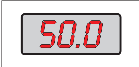
Abb. A-2: Anzeigebeispiel der LED-Anzeige am Frequenzumrichter
