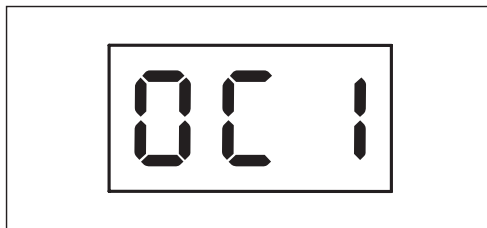
Abb. 8-1: Anzeigebeispiel einer Fehlermeldung an der LED-Anzeige des Frequenzumrichters
