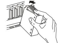
② Drücken Sie das Modul anschließend auf den Baugruppenträger, bis das Modul ganz am Baugruppenträger anliegt.
