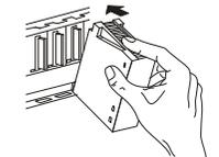
② Seguidamente empuje el módulo contra la unidad base hasta que el módulo quede pegado a la misma.
