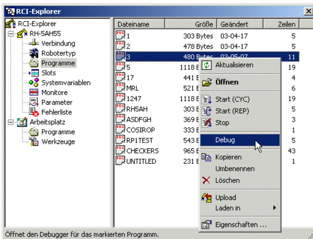
**Achtung!** Beim Debuggen führt der Roboter alle angegebenen Bewegungsbefehle aus.
