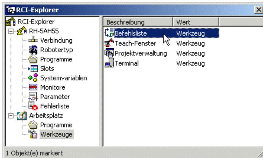
Sie können die Befehlsliste auch alternativ mit dem Befehl **Bearbeiten/Befehlsliste** öffnen. Mit dieser Dialogbox können Sie sowohl Befehle direkt zum Roboter senden, als auch Befehle in ein Roboterprogramm einfügen.
