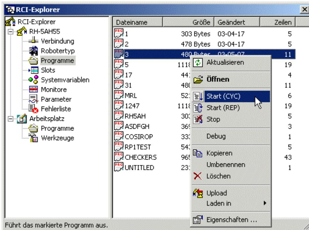
Es stehen zwei Startbefehle zur Verfügung. Beim Startbefehl "**Start (CYC)**" wird das Programm genau einmal (1 Cycle) gestartet. Beim Startbefehl "**Start (REP)**" wird das Programm dagegen immer wieder (Repeated) ausgeführt, solange bis es von außen gestoppt wird.
