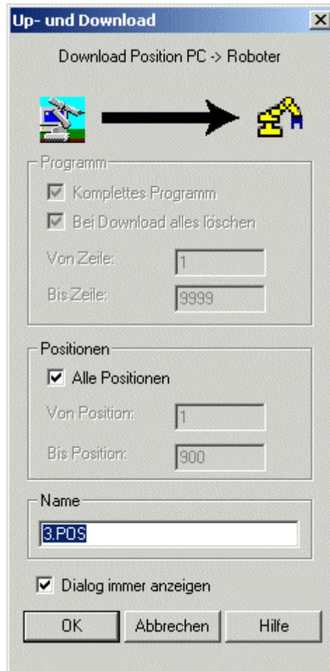
Vor dem Download wird der angegebene Positionsbereich gelöscht. Bei MELFA-BASIC IV werden die alten Positionen vor dem Download nicht gelöscht.
