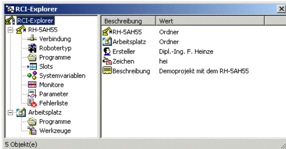
In Ihrem RCI-Explorer befinden sich stets zwei Ordner. Ein Ordner mit dem Namen des konfigurierten Roboters. In diesem Beispiel wird der "RH-5AH55" verwendet. Dieser Roboterordner enthält alle Daten, die sich auf der Robotersteuerung befinden. Der zweite Ordner heißt **Arbeitsplatz** und enthält alle Daten, die sich auf dem PC befinden, auf dem COSIROP gerade verwendet wird.
