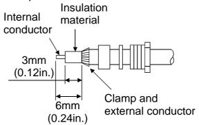
(d) Solder the contact to the internal conductor.
