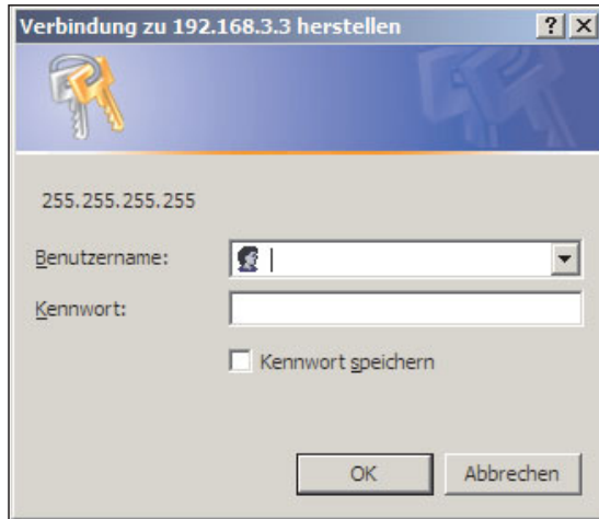
Abb. 4-36: Erst nach Eingabe eines im Web-Server-Modul gespeicherten Benutzernamens und Kennworts wird der Zugang zum QJ71WS96 freigegeben.
