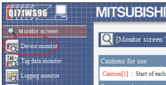
Abb. 4-23: ... und anschließend auf Device monitor .
