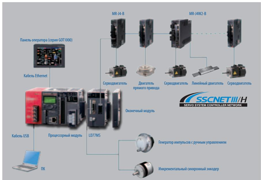
Конфигурация системы управления на базе ПЛК серии MELSEC L.
