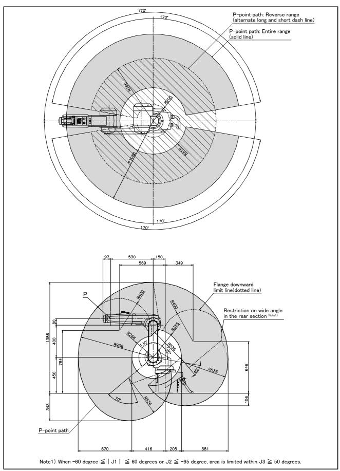
$Fig. 2-4: Operating\ range\ diagram: RV-18SD-S/18SDC-S$
