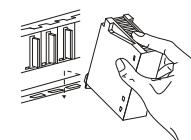
① Po vypnutí síťového napětí nasadte modul spodní západkou do otvoru na základní sběrnici.
