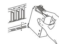
① Una volta disinserita la tensione di rete, introdurre il modulo nella guida del rack con la linguetta inferiore.
