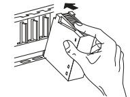
② Appuyer ensuite fermement sur le module dans l'appareil de base en s'assurant qu'il soit totalement enfoncé dans l'appareil de base.
