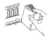
(1) Nachdem Sie die Netzspannung ausgeschaltet haben, setzen Sie das Modul mit der unteren Lasche in die Führung des Baugruppenträgers ein.
