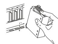
① Après avoir coupé l'alimentation électrique, introduire la patte inférieure du module dans le trou de guidage de l'appareil de base.
