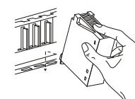
① Po wyłączeniu napięcia zasilania, należy dolny wyciąg modułu wsunąć do prowadzącego otwór, znajdującego się w płyce bazowej.
