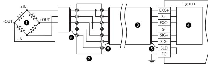
Collegamento a quattro fili / Conexión con cuatro cables / Четырехпроводное подключение
