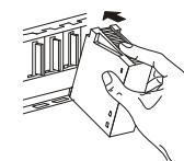
(2) Drücken Sie das Modul anschließend auf den Baugruppenträger, bis das Modul ganz am Baugruppenträger anliegt.
