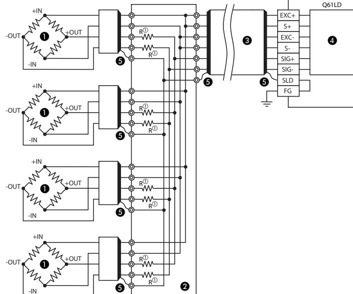
① Per ragioni di dissipazione, la resistenza media nel circuito parallelo deve essere compresa fra 300 Ω e 500 Ω. Le resistenze devono essere con basso coefficiente di temperatura. Se la tensione di uscita viene regolata nel caso di celle di carico collegate in parallelo, la resistenza (R) non è necessaria. /
