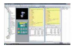
Имитационное моделирование роботов в RT ToolBox2
