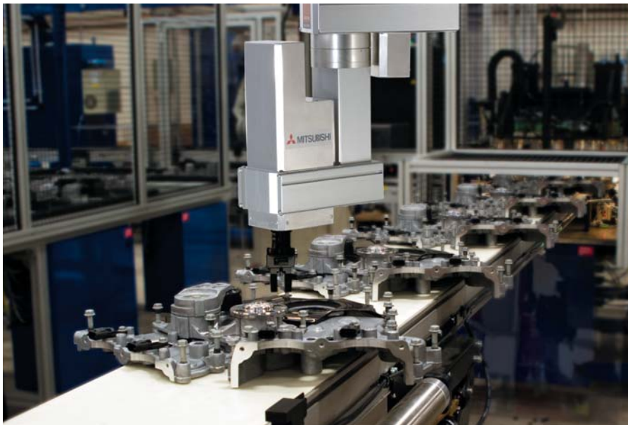
Platzsparende Überkopfmontage an der Decke bei schwierigen Raumverhältnissen
